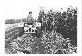
Mit dem KEMAIS-Ableger als Zusatz zum Traktorenbalken wird Grünmais in geordnete Mahden abgelegt. Das Mähgut nimmt der nachfolgende Ladewagen bzw. Feldhäcksler störungsfrei auf. (Ges. geschützt) vom IMA geprüft.
