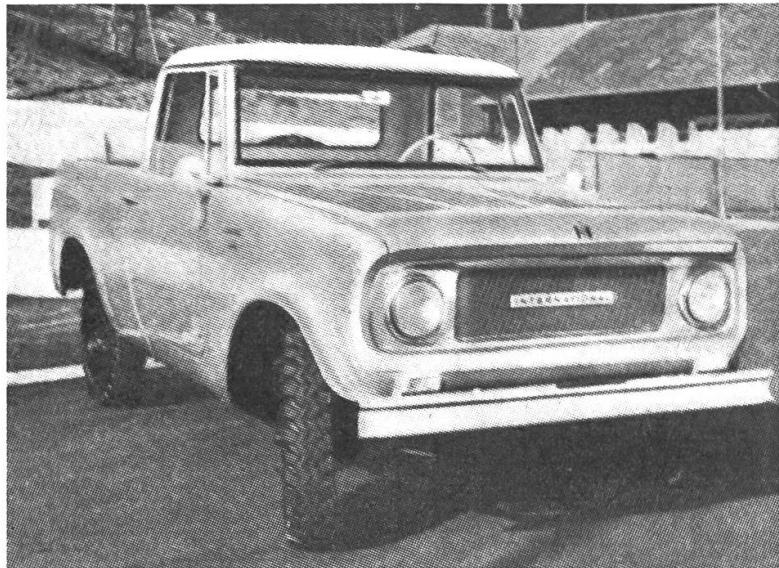
Der Scout verfügt über ein robustes, verwindungsfreies Fahrgestell. Seine grosse Bodenfreiheit bei niedriger Schwerpunktlage, breiter Radspur, extra-starken Stoßdämpfern, sowie dem kleinen Wendekreis bieten zahlreiche Einsatzmöglichkeiten in Land- und Forstwirtschaft. Antrieb: 2,5 Liter-Benzinmotor von 95 PS (SAE) Leistung.
