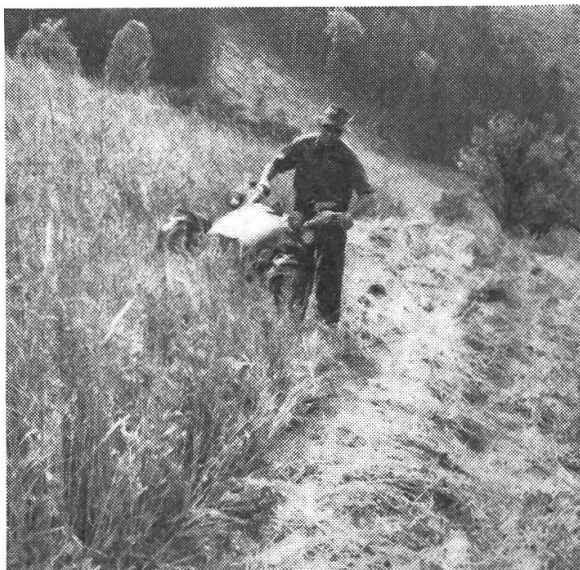
Abb. 4: Ein Einachstraktor mit einem 1,9 m breiten Mähbalken
