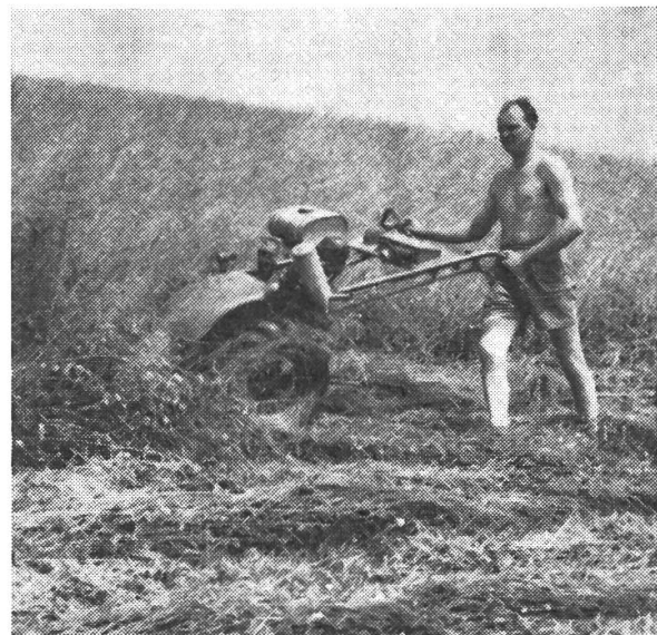
Abb. 5: Bei diesem Einachstraktor kann der Anschnittwinkel zwischen 2 und 8° verstellt werden.
