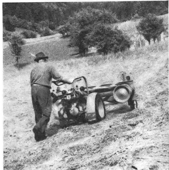
Abb. 6: Ein robuster Einachstraktor in Verbindung mit einem Heuer (Bandrechen).
