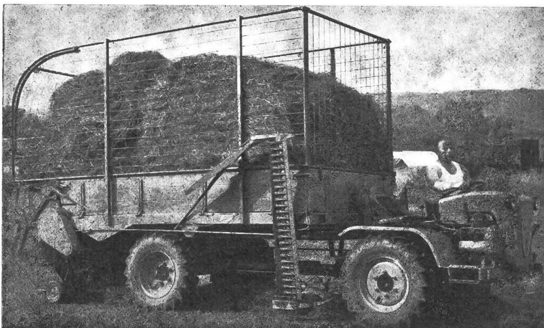
**Der Mähler-PULLAX** vereinigt in einer Einheit Ladewagen, Mähmaschine, Miststreuer sowie Entladewagen z. B. für Runkeln, Kartoffeln etc. Er kann mit wenigen Handgriffen an beliebiger Stelle abgesattelt werden. Dann kann der PULLAX verwendet werden als: Ackertraktor mit Normhydraulik, idealer Forstraktor, Kipper, Schneeräum-Maschine etc. etc.
