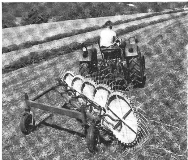
Abb. 7 u. 8: Der Vorteil des Front-Sternradrechens liegt vor allem darin, dass das Heu nicht wie bei der gezogenen Ausführung vom Traktor überfahren wird. Andererseits ist der Heckanbau bei der Arbeit am Hang günstiger.
