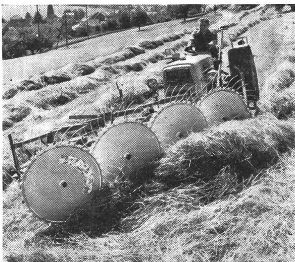
Abb. 7 u. 8: Der Vorteil des Front-Sternradrechens liegt vor allem darin, dass das Heu nicht wie bei der gezogenen Ausführung vom Traktor überfahren wird. Andererseits ist der Heckanbau bei der Arbeit am Hang günstiger.
