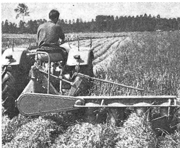
Abb. 6: Kreiselmäher bei der Arbeit: Das Gras wird an zwei lockere Schwaden gelegt. Dieses Mähwerk hat einen hohen Leistungsbedarf. Damit auch schwächere Traktoren eingesetzt werden können, kommt neu ein Kreiselmäher mit 1,1 m Arbeitsbreite auf den Markt.
