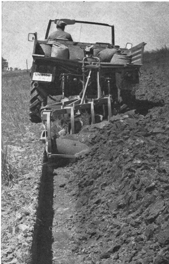
Abb. 1: Der Gedanke vom starken Traktor ist in der Landwirtschaft nichts Neues. Früher war es in Gestalt des Dampf-Pfluges verwirklicht, an dessen Stelle später die Raupen trat. Heute rückt der stärkere Rad-Traktor mehr und mehr in den Vordergrund. Das Problem dabei ist, die Motorkraft an den Boden zu bringen. Der Allradantrieb bietet dafür eine Möglichkeit.
