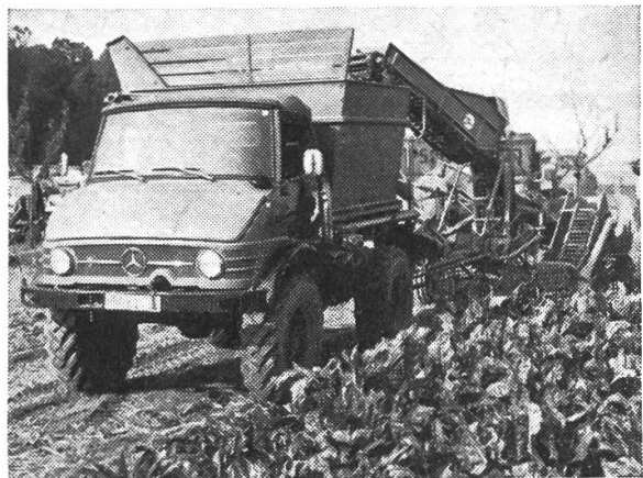
Abb. 3: Der Hochkippbunker fasst 50 Ztr. Zuckerrüben. Das reicht für jede Schlaglänge, meistens sogar für eine Hin- und Herfahrt, so dass die Rüben an nur einem Feldende gelagert werden können. Unterwegs werden sie auf dem Unimog über angetriebene Achsen gesammelt. Ihr Gewicht hilft also, die Zugkraft noch besser auszunutzen. Mit diesem Gespann wird auch bei schlechter Witterung zuverlässig gearbeitet, zumal der Fahrer geschützt sitzt. Den Köpfröder kann er von seinem Sitz aus bequem überwachen und hydraulisch steuern.
