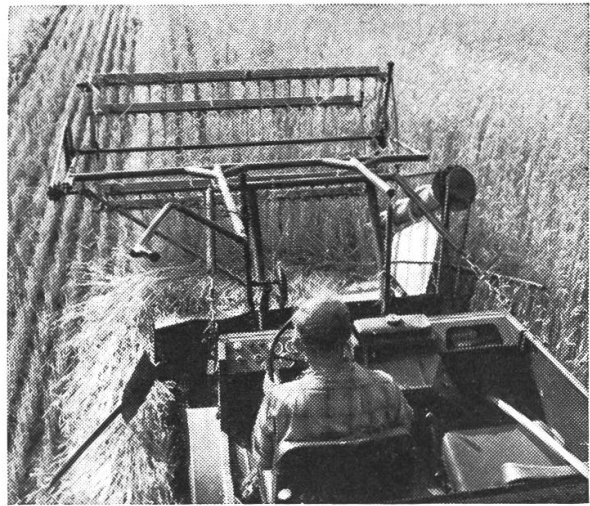
Abb. 2: Getreideernte mit dem Frontschwadleger – das moderne Ernteverfahren. Gute Übersicht hat der Traktorfahrer auf das Gerät, das er von seinem Sitz aus bequem bedienen kann. Angetrieben wird es über die vordere Zapfwelle, ausgehoben vom vorderen Kraftheber. Das Getreide wird zur besseren Lüftung auf hohe Stoppeln gelegt.
