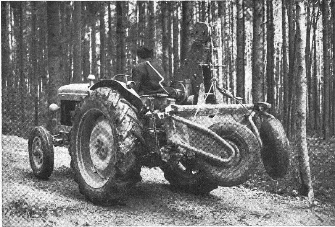
Fig. 1: Das Rückgerät am Traktor im Dreipunktkraftheber angehoben für Strassenfahrten zur Arbeitsstelle.
