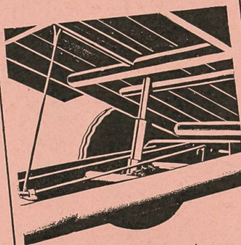
Hydraulisches Kippen der Ladebrücke bei Typen II+III
