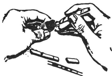
Nachstellen der Masse-Elektroden mittels Biegevorrichtung
