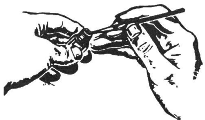
Reinigen des Zündkerzen-Innern mit dem Zündkerzen-Reiniger
