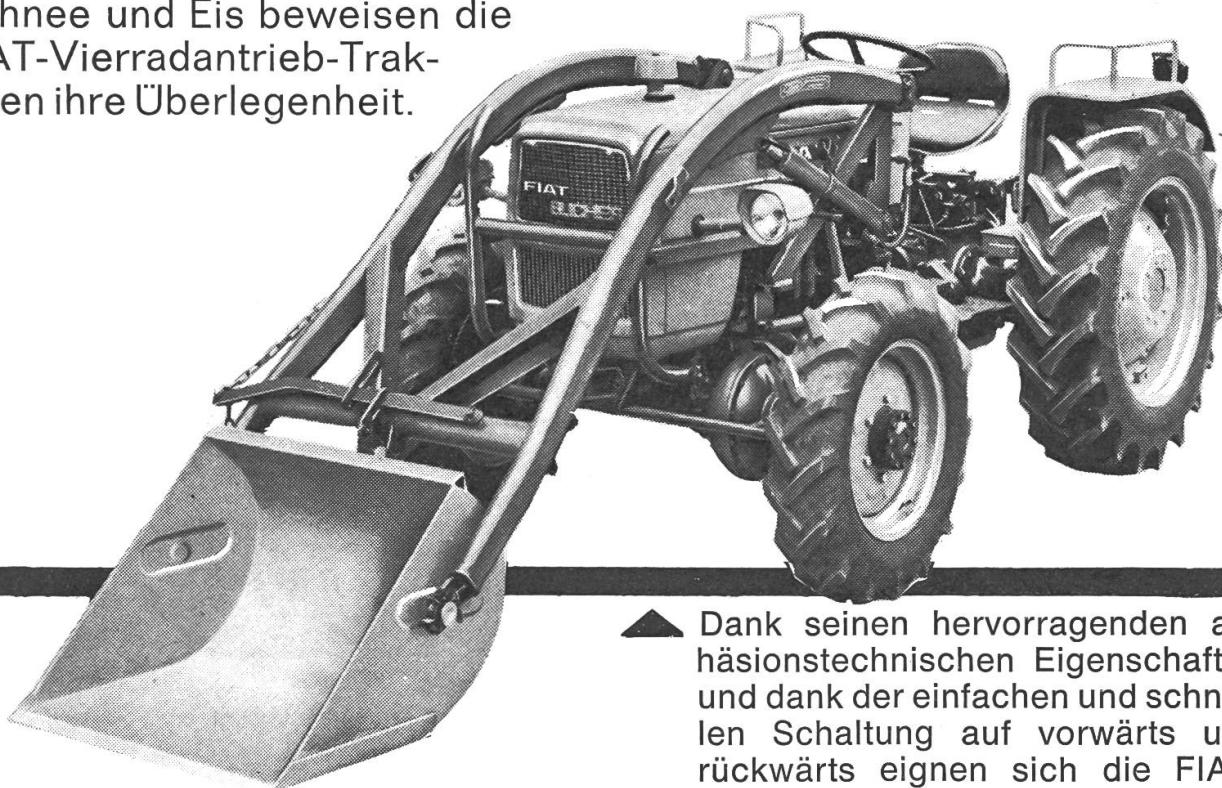
▲ Dank seinen hervorragenden adhäsionstechnischen Eigenschaften und dank der einfachen und schnellen Schaltung auf vorwärts und rückwärts eignen sich die FIAT-Vierradantrieb speziell auch für den Umgang mit dem Frontlader.
