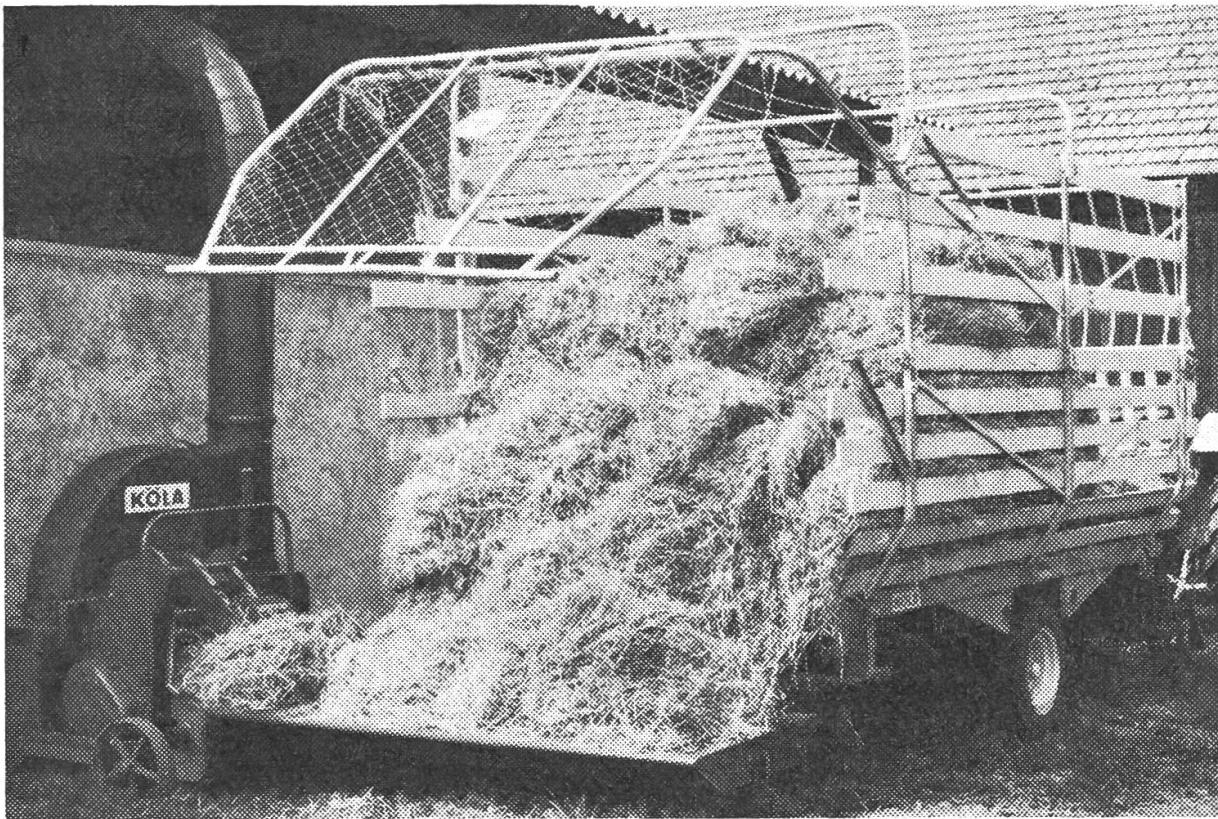
Das grosse KÖLA-Ladewagenprogramm enthält für jede Betriebsgrösse den geeigneten Typ. Normalspur oder Tief- lader, Seiten- oder Hinteranhängung. Möglichkeit zum Umbau als Miststreuer, auf Wunsch mit Schneidevorrichtung. Günstige Fahrzeughöhe, der Trocken- futteraufbau ist ab- klappbar und mit einer Arretierung versehen. Grosse Bodenfreiheit
