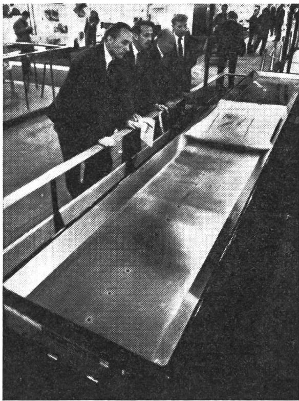
In einer Stunde bewegt eine Förderanlage englischer Konstruktion 3600 Säcke, von denen jeder etwa 50 kg wiegt, in einer 30 Meter langen Transportrinne mit einer Geschwindigkeit bis zu 1,5 m je Sekunde. Die Vorwärtsbewegung geschieht bei einem Gefälle von höchstens 5 cm durch einen kleinen Elektromotor, wie sie gewöhnlich in Staubsaugern für Haushaltzwecke benutzt
