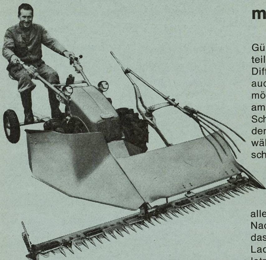
**Dank dem eingebautem Differential ein leicht steuerbarer Eingrasmäher mit grosser Leistung.**
