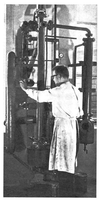
Pilot-Destillationsanlage der ASEOL
