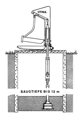
Abb. 5: Tiefsauge-Weidepumpe mit einer Saugtiefe bis 12 m.
