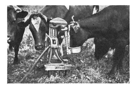
Abb. 1: Selbsttränke-Weidepumpe mit pendelnder Tränkeschale, Schlauchgarnitur und Fussventil.
