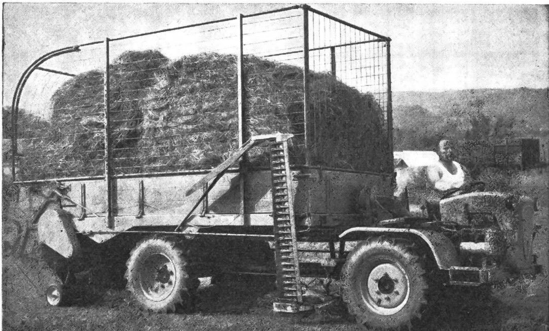
**Der Mählader-PULLAX** vereinigt in einer Einheit Ladewagen, Mähmaschine, Miststreuer sowie Entladewagen z. B. für Runkeln, Kartoffeln etc. Er kann mit wenigen Handgriffen an beliebiger Stelle abgesattelt werden. Dann kann der PULLAX verwendet werden als: Ackertraktor mit Normhydraulik, idealer Forstraktor, Kipper, Schneeräum-Maschine etc. etc.
