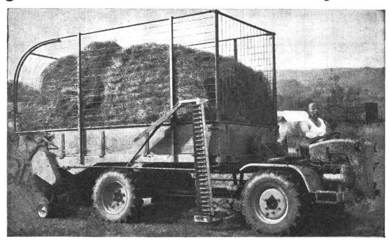
Der Mählader-PULLAX vereinigt in einer Einheit Ladewagen, Mähmaschine, Miststreuer sowie Entladewagen z.B. für Runkeln, Kartoffeln etc. Er kann mit wenigen Handgriffen an beliebiger Stelle abgesattelt werden. Dann kann der PULLAX verwendet werden als: Ackertraktor mit Normhydraulik, idealer Forsttraktor, Kipper, Schneeräum-Maschine etc. etc.
