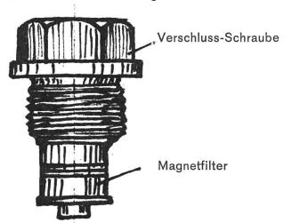
Bei Oelwechsel bzw. Erneuerung des Getriebeöles ist nun, besonders in den Kundendienstwerkstätten, darauf zu achten, dass die Oelablaßschraube erst dann wieder eingeschraubt wird, nachdem der metallische Abrieb, der sich evtl. am Magnetstopfen angesammelt hat, gründlich entfernt wurde. Nur dadurch kann eine Dauerfunktion des Magnetfilters gewährleistet und somit ein vorzeitiger Verschleiss des Getriebes verhindert werden. K.F.
