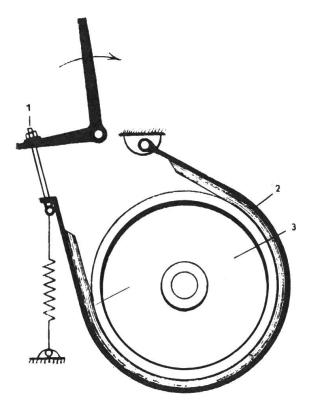
Abb. 1: Bandbremse 1 = Nachstellschraube
