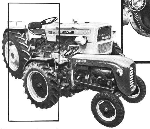
Die Konstrukteure der BUCHER- und FIAT-Diamant-Traktoren sind sich einig: Der Schrägritzelantrieb bietet mehr! Durch die schräge Anordnung des Ritzels wird der Radstand verlängert und damit das gefährliche Aufbäumen verhindert. Schrägritzel bedeutet ausserdem erhöhte Bodenfreiheit, grösseres Zugvermögen und den praktischen, freien seitlichen Aufstieg. Der BUCHER D 4000 und alle FIAT-Diamant-Traktoren besitzen darum Schrägritzelantrieb.
