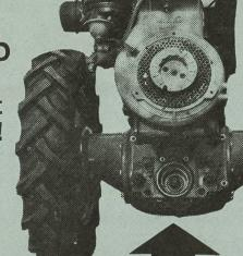
Der RAPID 606 besitzt 4 Vorwärtsgänge und 1 Rückwärtsgang, mit einem Hebel schaltbar, Schalterleichterung im 3./4. Gang, gehärtete Zahnräder aus Chromstahl, Kegelradgetriebe, grosse Reifen 5,00 – 16". Pat. schwingungsdämpfender Mähausleger, Schnellverschluss für Mähbalken, Ratschkupplung.
