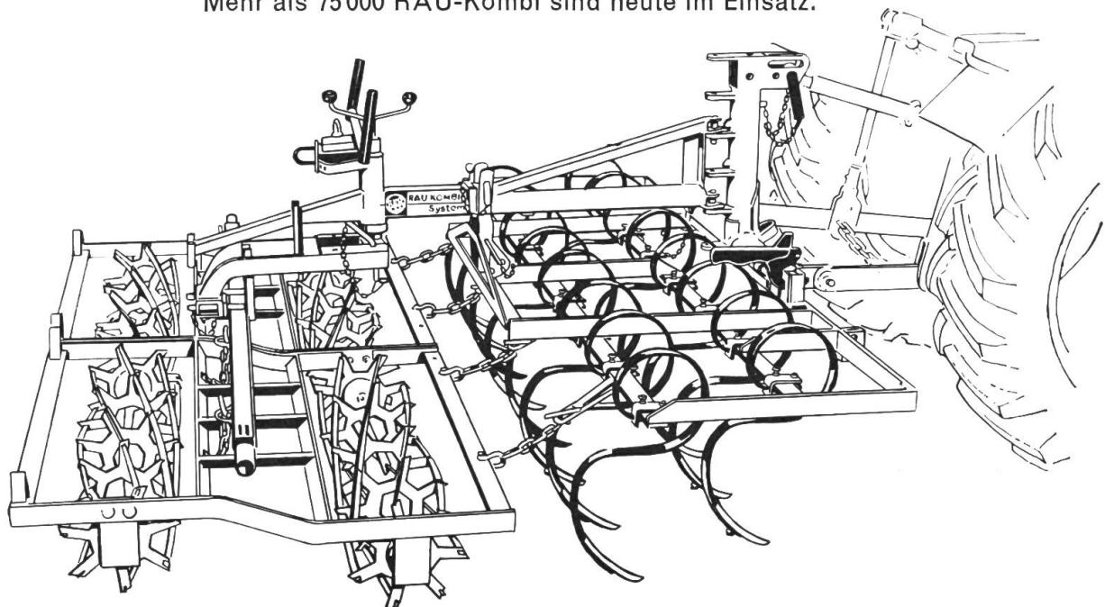
2-balkige Federzahngesge und Krümler, speziell für schwere und steinige
