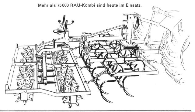
2-balkige Federzahnegge und Krümler, speziell für schwere und steinige Böden geeignet.
