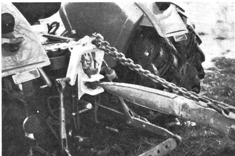
Abb. 2: Strebelmatik von J. Strebel, Butwil. Die Entlastung des Anhängers bzw. Belastung der Traktorhinterachse wird mit einer Kette über die Regelhydraulik erreicht und geregelt.
