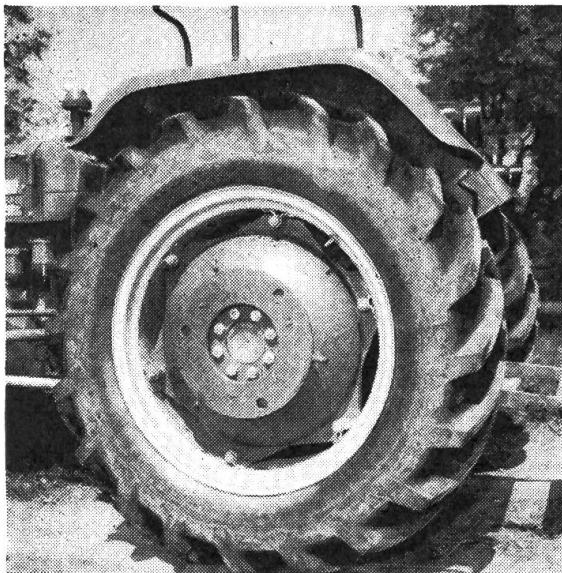
Abb. 5: Das Verbindungsstück besteht in einer aufgeschraubten Platte mit 3 nicht vorstehenden Haken. Keine Gefahr des Hängenbleibens!
