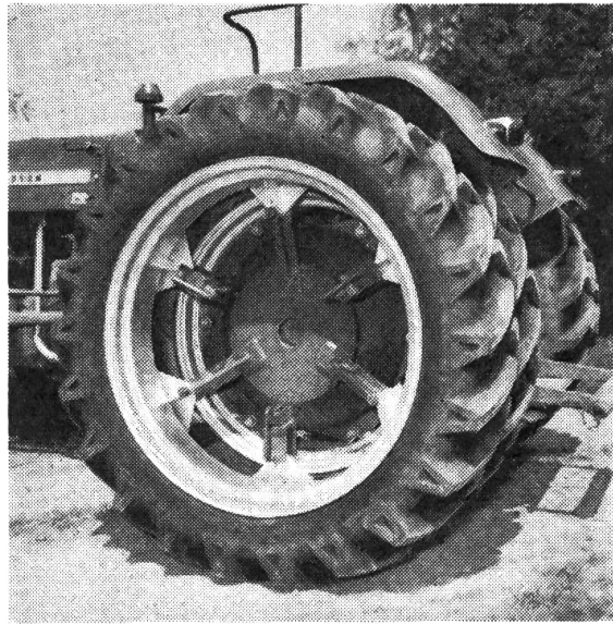
Abb. 5a: Der Zwillingsreifen ist angebaut. Mit 3 Schnellverschlüssen kann das Doppelrad an- und abgebaut werden. Innert 1 Minute sind beide Doppelreifen entfernt.
