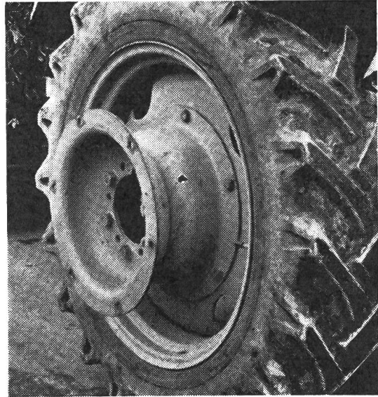
Abb. 4: Das Verbindungsstück steht zu weit vor. Es sind jedoch keine vorstehenden Schrauben vorhanden. Der Durchmesser des Verbindungsstückes ist gross. Der Anbau mit 6 losen Schrauben ist zu mühsam.
