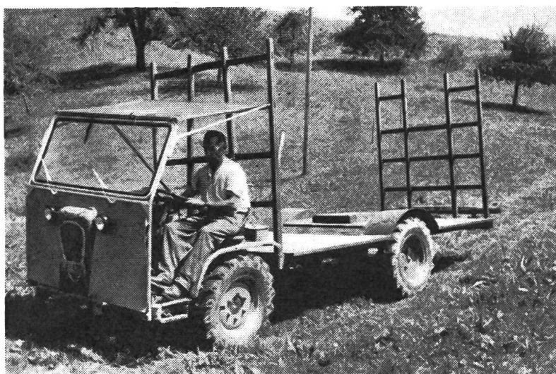
Abb. 7: Wird der Hang zu steil, dann versagt der Traktor als Zugmaschine. Es kommt der «Säumer». Die Last muss zwischen die Räder geladen wer- den, und alle 4 Räder müssen angetrieben werden. Eine niedere Brücke erleichtert das Aufladen. Brücke auf Bild ist nur 65 cm über Boden.
