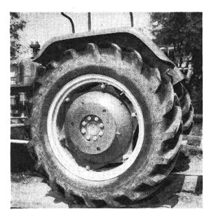
Abb. 5: Das Verbindungsstück besteht in einer aufgeschraubten Platte mit 3 nicht vorstehenden Haken. Keine Gefahr des Hängenbleibens!
