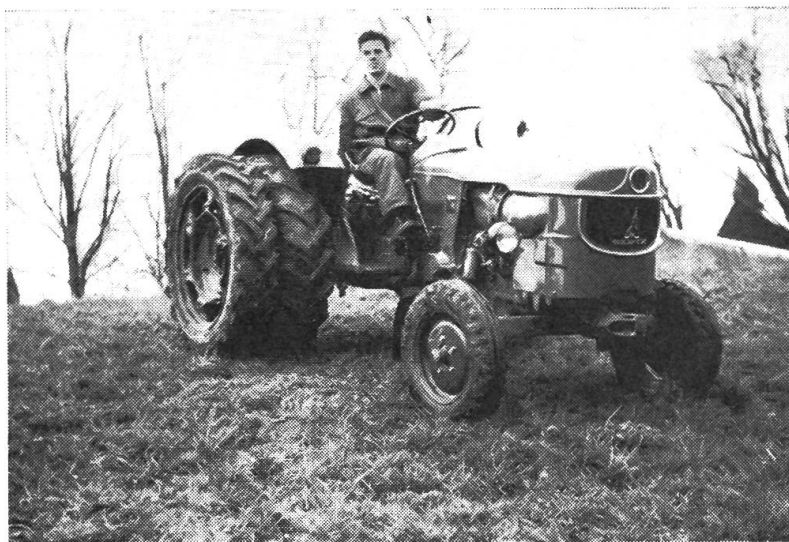
Abb. 6: Mit Doppelreifen ist der Traktor am hang- sichersten ausge- rüstet.
