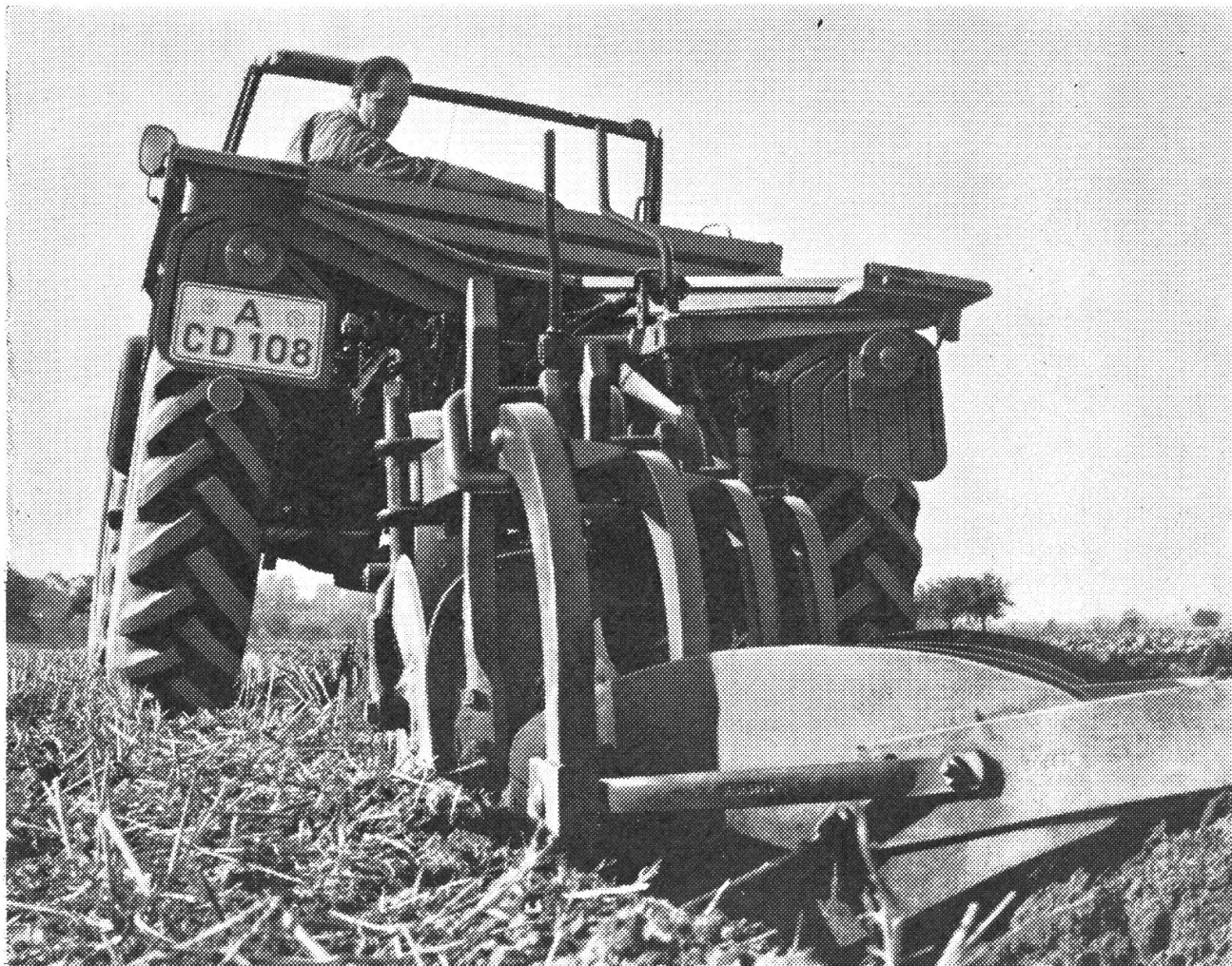
Unimog 406 mit einem vierscharigen Pflug. Dieses Foto beweist, wie gut die Sicht nach hinten ist.
