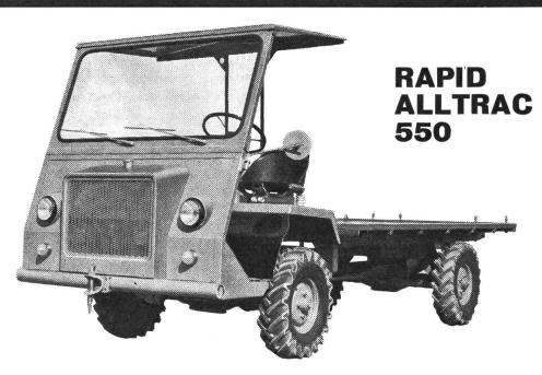
Der neue Transporter für Mittelland und Berggebiet: robust wie ein Landwirtschaftstraktor, bequem wie ein Personenwagen. Sein 9-Gang-Getriebe verleiht ihm beste Steigfähigkeit. Der Fahrkomfort ist ausgezeichnet dank spezieller Sitzfederung mit hydraulischer Stossdämpfung. Hydraulische Vierradbremsen gewährleisten die Sicherheit in allen Situationen. Verlangen Sie unverbindlich unseren Prospekt!
