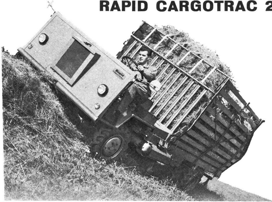
Dieser 30 PS Selbstfahr-Ladewagen ist der kleinere Bruder des 1964 an der DLG in Hannover als Weltneuheit ausgestellten RAPID CARGOTRAC 30. Er besteht aus einem von der RAPID eigens für dieses Spezialfahrzeug entwickelten Triebwerk, auf dem der tausendfach bewährte Steyr
