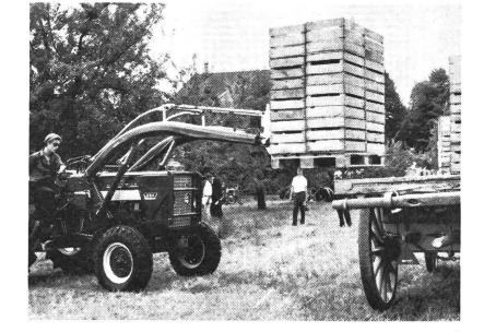
Abb. 5: Frontlader beim Harassen-aufladen. Das Parallelführungsgestänge erlaubt die senkrechte Haltung des Stapels.
