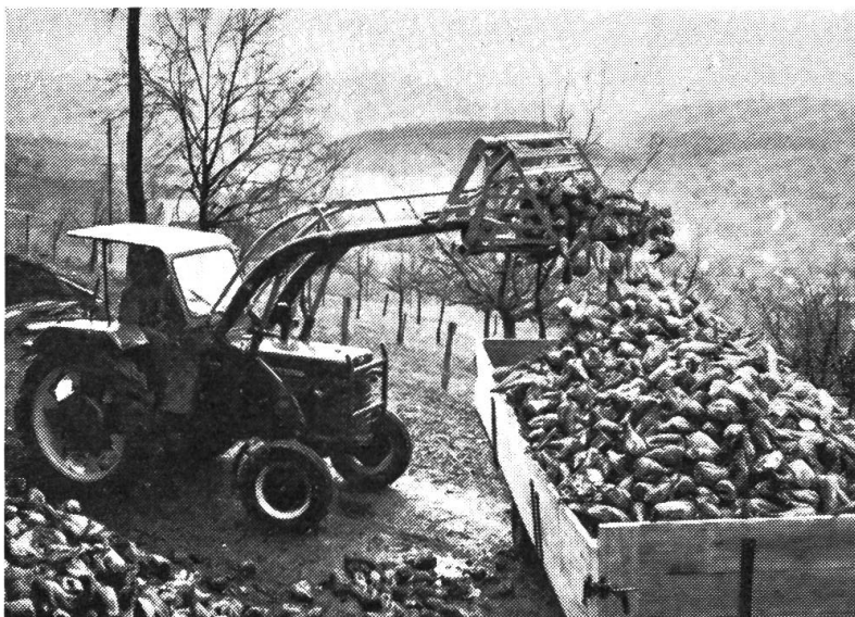
Abb. 3: Frontlader mit Abschiebe- gabel beim Rübenladen. Eben wird die hydraulisch zu betätigende Abschiebewand nach vorne gestossen. Diese Einrichtung erlaubt eine Vergrösserung der Ladehöhe und des Ueberstandes.
