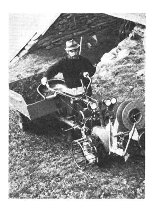
Abb. 10: Radverbreiterung in Form von Gitterrädern begünstigten die Schrägfahrten am Hang.
