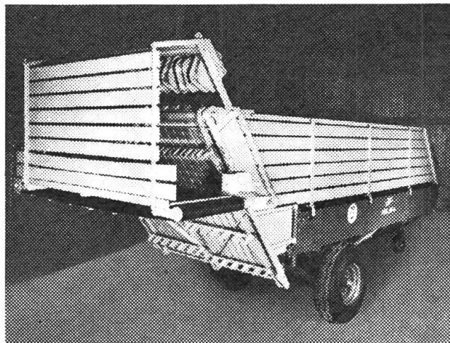
Auch als Häckselwagen mit Kombi- und Seitenablader ist der JF-Allzweckwagen beim Eingrasen, Silieren und bei der Zukerrübenernte eine unschätzbare Hilfe. Garantiert gleichmässiges Abladen. Sehr wichtig für die Weiterbeförderung.
