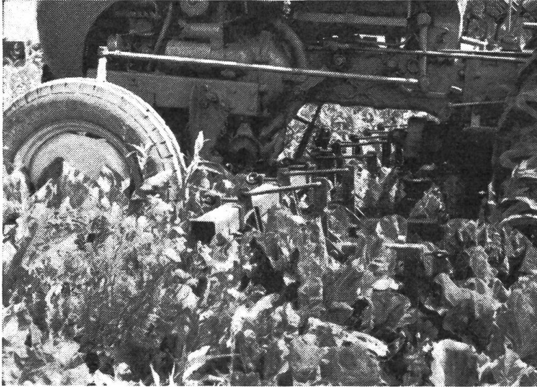
Abb. 2: Ein Zwischenachsgerät in abgesenktem Zustand
