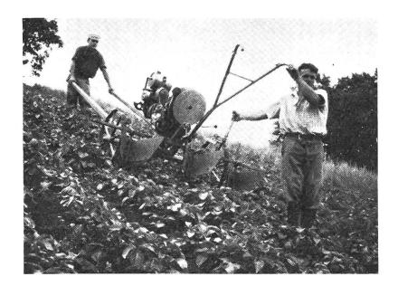
Abb. 2: Die Selbstaufzugwinde auf dreireihigem Gespann-Vielfachgerät hat sich in einem Hangbetrieb für Kartoffel-Saatgutproduktion gut bewährt.
