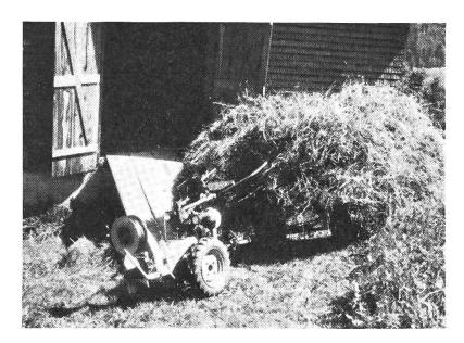
Bei der Durchführung der Tastversuche verursachte die zu geringe Bodenfreiheit der Frontwinde von nur 8 cm beim Befahren von Bodenwellen oder beim Ueberqueren von Fuss- oder Fahrwegen Schwierigkeiten, indem die Umlenkrolle der Seilwinde auf dem Boden aufstiess. Um trotzdem die Versuche fortsetzen zu können, wurden anstelle der normalen Reifen von 3,5—8" solche von 5,00—12" verwendet, wodurch die Bodenfreiheit von 8 auf 17 cm erhöht werden konnte. Diese Bodenfreiheit erwies sich selbst bei
