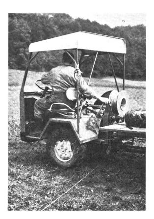
Abb. 3b: Transporter (Motorkarren) kombiniert mit Seilaufzugwinde. Auf dem Bild beim Einsatz im Normalseilzug.
