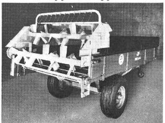
Der JF-Allzweckwagen ist mit Normalstreu-, Breitstreu- und Doppelstreuwerk lieferbar. Die Streuleistung liegt weit über dem Durchschnitt. Mit dem Doppelstreuwerk und den Stahlaufsatzwänden wird die Nutzlast stark erhöht.
