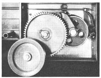
Wenig arbeitende Teile garantieren höchste Betriebssicherheit. Die Zahnräder des Winkelgetriebes sind aus gehärtetem Chromnickelstahl und laufen im Olbad. Dank Keilriemenantrieb gegen Überlastung gesichert.
