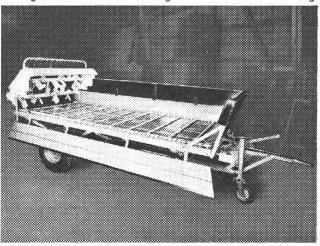
Dieser Rollboden hält wirklich mehr aus! Die spezial-gewalzten Stahlprofilkettenglieder haben eine einzigartige Bruchfestigkeit. Schnelles Abladen dank 5 Vorschubgeschwindigkeiten. Sehr leichtes Reinigen der Ladebrücke.
