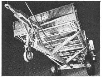
Ein Rahmen mit einzigartiger Verwindfestigkeit. Er hält auch Zusätzliches aus. Der sehr geringe Kraftbedarf, die spez. Ballonreifen und das niedrige Eigengewicht erhöhen die Einsatzgrenze stark. Eine Jahresproduktion von 10 000 Wagen ermöglicht einen niedrigen Preis.
