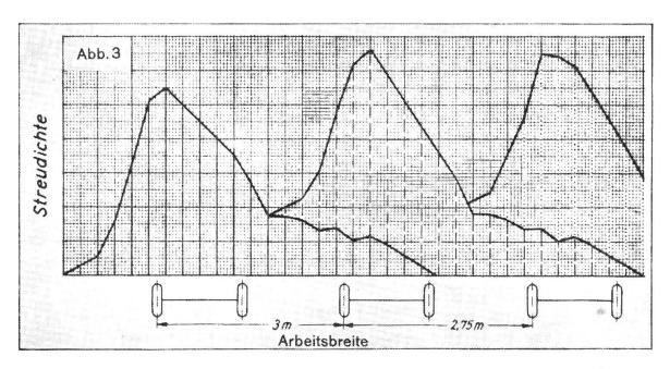
Abb. 3: Querschnitt durch die Düngerverteilung eines Streuers mit 3 stehenden Walzen.
