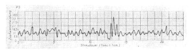
Abb. 4: Zapfwellenleistungsdiagramm.
