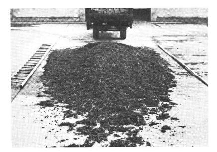
Abb. 2: Streukegel eines Heckstreuers mit liegenden Walzen.
