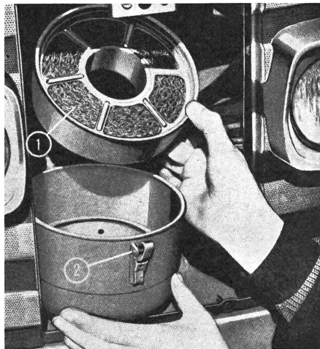
Abb. 2: Richtig! Luftfilter in gereinigtem Zustand. 1 = Filtereinsatz 2 = Oelwanne
