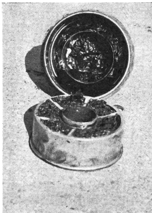
Abb. 1: Falsch! Ein vollständig verschmutzter Luftfilter, wie man ihn nirgends antreffen sollte.
