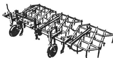
Ganzstahlkonstruktion mit langen gehärteten Zinken, schwere Ausführung.
