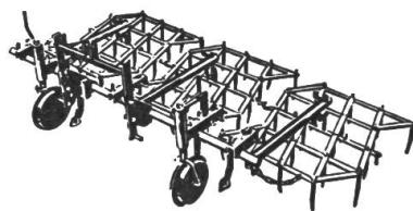
Ganzstahlkonstruktion mit langen gehärteten Zinken, schwere Ausführung.
