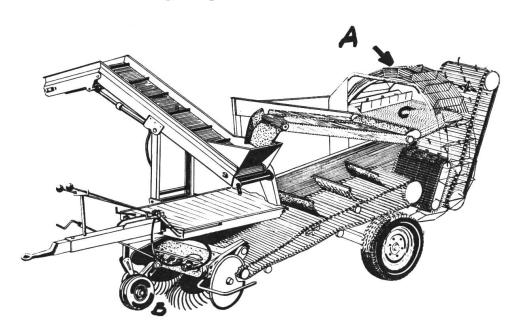
Abb. 17: Bei dem neuen Vollernter «Wisent» befindet sich das Hubrad (A) nicht mehr seitlich, sondern hinten. An Stelle der Grabschar weist die 2-reihige Ausführung zwei Siebräder (B) auf. Zum Ausscheiden von Steinen und Erdschollen werden die Wisent-Maschinen mit einem Finger-Gummiband (C) ausgerüstet.
