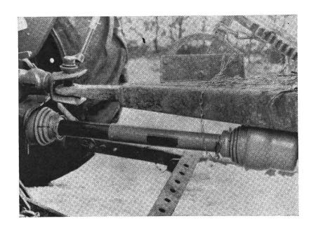
Abb. 5: Gelenkwelle wird gegen Anhängekupplung gedrückt
