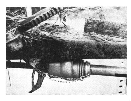
Abb. 1: Zu kurz angehängte Haltekette
