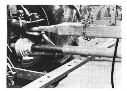
Abb. 6: Ackerschiene drückt gegen die Gelenkwelle
