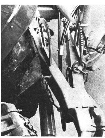
Abb. 7: Traktorreifen drückt gegen die Gelenkwelle
