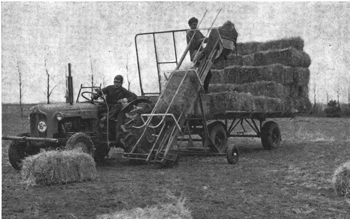
Abb. 15: Mit den neukonstruierten Ballenlader «Vicon» wird die Ladearbeit wesentlich erleichtert.
