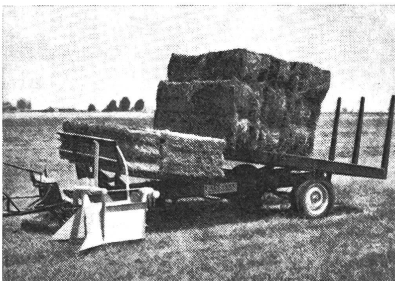
Abb. 16: Der Selbstlade-Anhänger «New Holland» ermöglicht ein vollautomatisches Laden und Abladen von Hochdruckballen. Man beachte die Arbeitsvor- gänge der Maschine:
