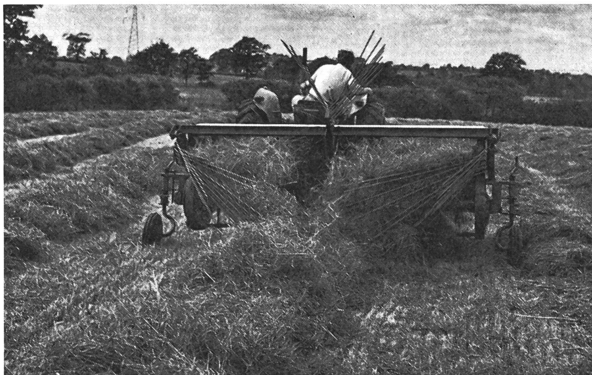
Abb. 13: Der Zettwender «Lely» kann nach Anbringen von 4 oder 2 Fangrechen auch zum Ziehen von Klein-, bzw. Großschwaden benützt werden.
