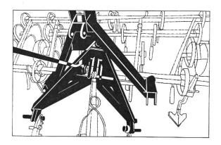
Beim Kuppeln gleitet das Traktoren-Dreieck in das Geräte-Dreieck, richtet sich automatisch und stellt eine form- und kraftschlüssige Verbindung her. Auch aus extremen Schrägstellungen können die Geräte und Maschinen mühelos gekuppelt werden.
