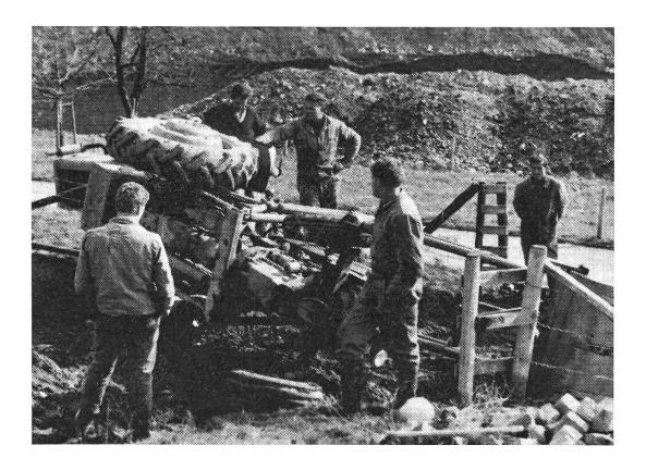
Der Fahrer dieses Traktors mit vorderem Frontlader hat offenbar nicht daran gedacht, dass bei beladenem Frontlader das Abwärtsfahren gefährlich werden kann. Plötzlich kippte der Traktor nach vorne. Der Fahrer konnte sich rechtzeitig durch Abspringen retten. — Man denke beim Einsatz der hydraulisch betätigten Lader, dass der Schwerpunkt des Traktors je nach Gewicht und Lage stark verschoben wird.
