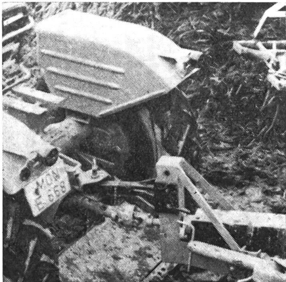
Abb. 4: Freilaufendes Kreuzgelenk am Dunglader
