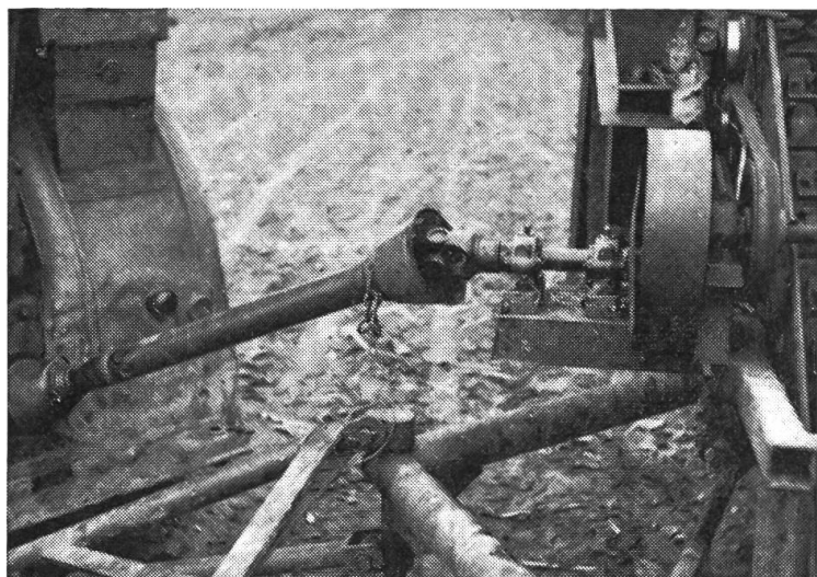
Abb. 2: Ungeschützte Kreuzgelenke am Pendeldüngerstreuer
