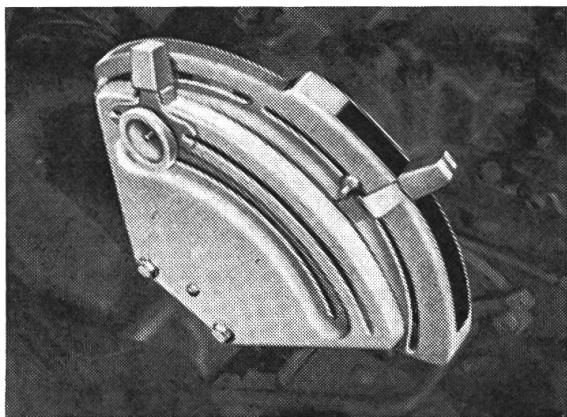
Etwas völlig neues in der Ferguson-Hydraulik bietet der Zugkraftverstärker. Durch ihn lässt sich mit Hilfe der Hydraulik das Ferguson-System auch bei aufgesattelten und angehängten Geräten sowie bei Anhängern und 4-Rad-Wagen anwenden.
