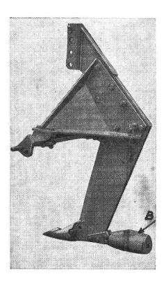
(Abb. 3). Mit diesen Geräten, die im wesentlichen aus einem ca. 60 cm langen Sech mit einer Meisselschar bestehen, wird die undurchlässige Erdschicht durchschnitten und aufgelockert. Neben der Durchlüftung wird damit auch die unterbrochene Verbindung mit dem Untergrund wieder hergestellt. Für die Durchführung der Drainagearbeit (Maulwurfdrainage) wird an der Meisselschar ein geschossförmiger Schleppkörper angehängt (Abb. 4). Unter Einwirkung dieses Körpers verbleiben im Boden Drainagerillen, die
