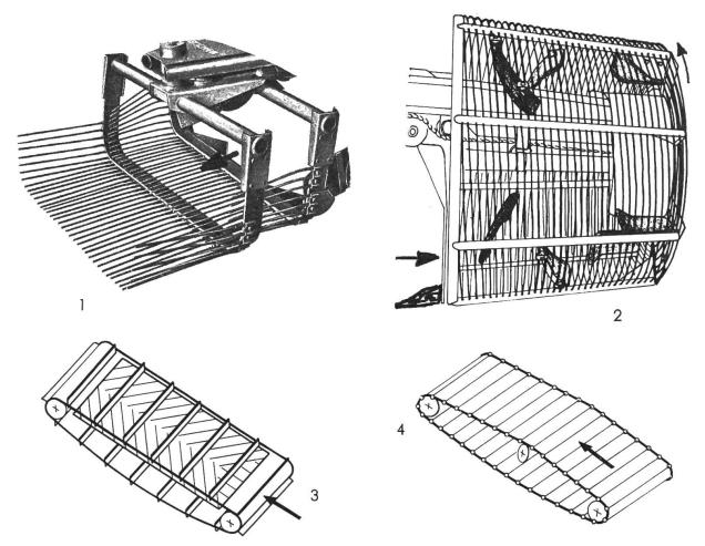
Abb. 6: Sieborgane der untersuchten Maschinen:
