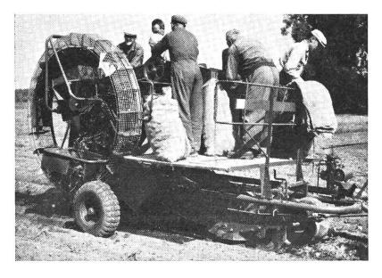
Abb. 3: Siebrost-Sammelgraber (Vollernter) mit Absackung
