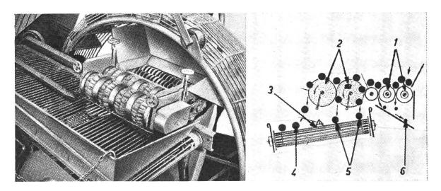
Abb. 10: Dreistufiger Fremdkörperausscheider des Siebrost-Sammelgrabers: 1. Scheibenwalzen, 2. Tellerbürsten, 3. Verleseband mit Trennleiste, 4. Kartoffeln, 5. Steine, 6. lose Erde, kleine Kartoffeln, Steine, Erdschollen etc.
