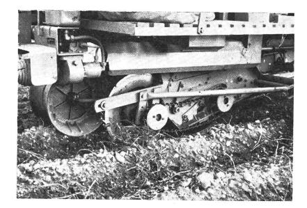
Abb. 5: Dammrolle und Scheibensech eines Vollernters
