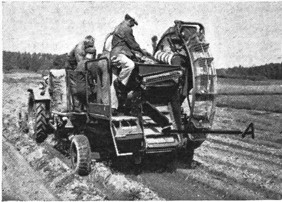
Abb. 7 und 8: Das Ausscheiden von Kartoffelstauden erfolgt beim Siebrost-Sammelgraber (Abb. 7) mit der Kratzer-Förderkette A und beim Siebketten-Sammelgraber (Abb. 8) mit einer speziellen weitmaschigen Krautkette B.
