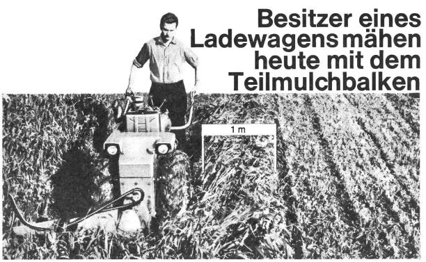
Der Teilmulchbalken macht eine ähnliche Doppelmahd wie der übliche Mahdenformer, aber sie ist so schmal, dass die Traktorräder rittlings darüber fahren, ohne das Futter zu berühren. Die linke Seite des Messerbalkens ist mit Mulchfingern besetzt und hat kein Mahdenblech mehr. So kann dieses Balkenende unter der ersten Mahd durchschlüpfen, während ein Spezialabweisblech die zweite Mahd unmittelbar
