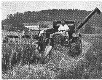
Traktor und Mähdrescher bilden eine kompakte Einheit. Wende radius, Manövrierfähigkeit, Übersicht und Bedienung sind wie be einem Selbstfahrer
