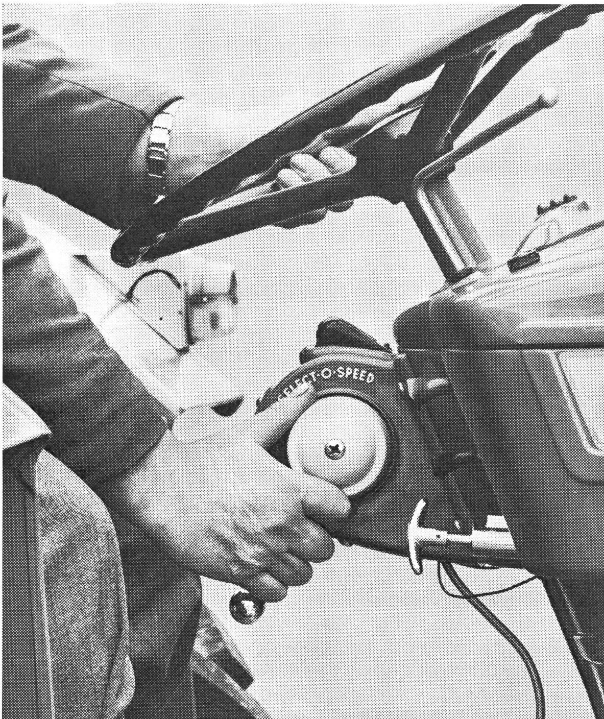
Linke Hand auf dem Lenkrad, rechte Hand auf dem Schalthebel des Select-o-Speed Getriebes... und weg! Vorwärts (9 Gänge), rückwärts (2 Gänge) ... ohne Schalthalt, ohne zu kuppeln,
