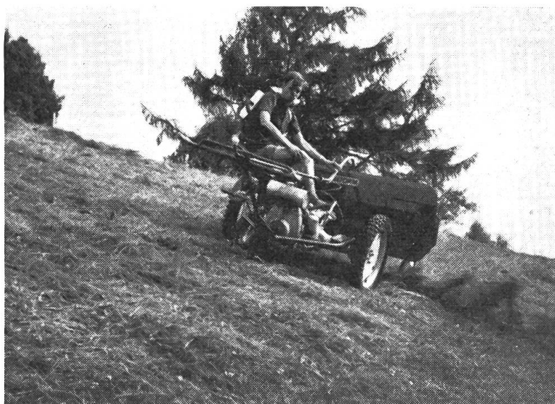
Abb. 1: Versuche über die Kraftanstrengung mit der Respirationsgasuhr bei der Arbeit mit einem Motorheuer.
