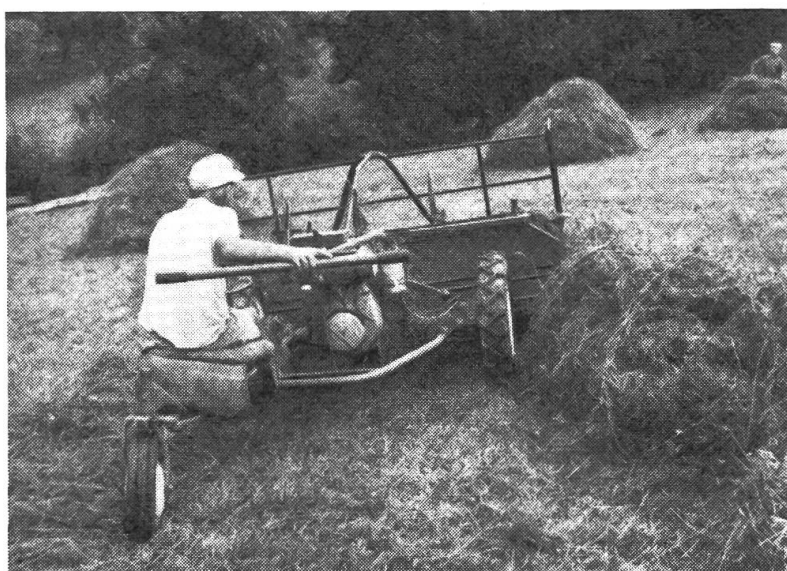
Abb. 2: Ein Heuer mit Nachlaufsitz beim Schwaden.
