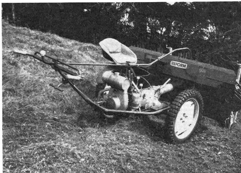
Abb. 4: Ein Heuer mit quer zur Fahrtrichtung montiertem Sitz und Stützradlenkung
