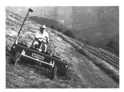
Das Getriebe wird mit zwei Hebeln geschaltet. Es trägt dem speziellen Verwendungszweck Rechnung, indem mit dem einen Hebel vier Gänge und mit dem anderen nur die Richtung, also Vor- und Rückwärtsfahrt, geschaltet wird (Wendegetriebe). Die Schaltung ist leicht zu bedienen und die Gangabstufung untereinander sehr günstig.
