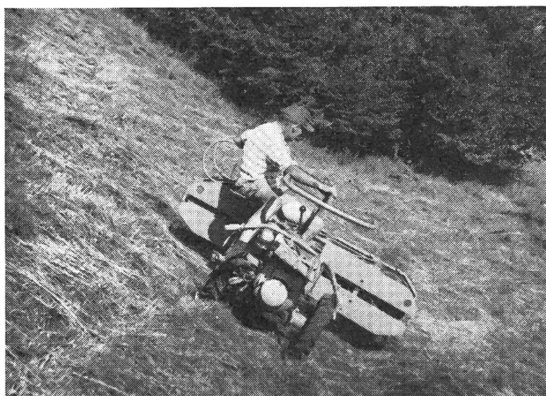
Abb. 5: Dieser Heuer ist ein Zusatzgerät zu einem Motormäher. Die Sitz- anordnung ist ebenfalls quer zur Fahrtrichtung
