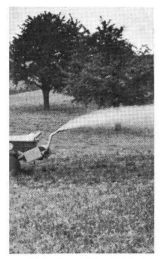
uckfaß beim Güllen (12 m Streubreite). impe erfolgt über die Zapfwelle.
