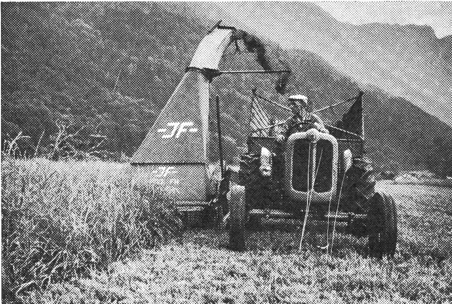
Der JF-MÄHFELDHACKSLER beim Mähen und Aufladen von Gras. Er ist leicht in der Bedienung und vielseitig in der Verwendbarkeit.
