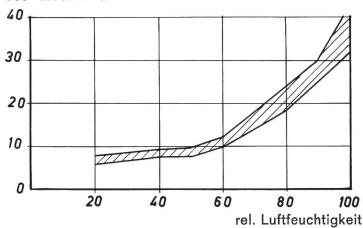
Abb. 2: Feuchtigkeitsgleichgewicht zwischen Luft und Heu nach Zink.
